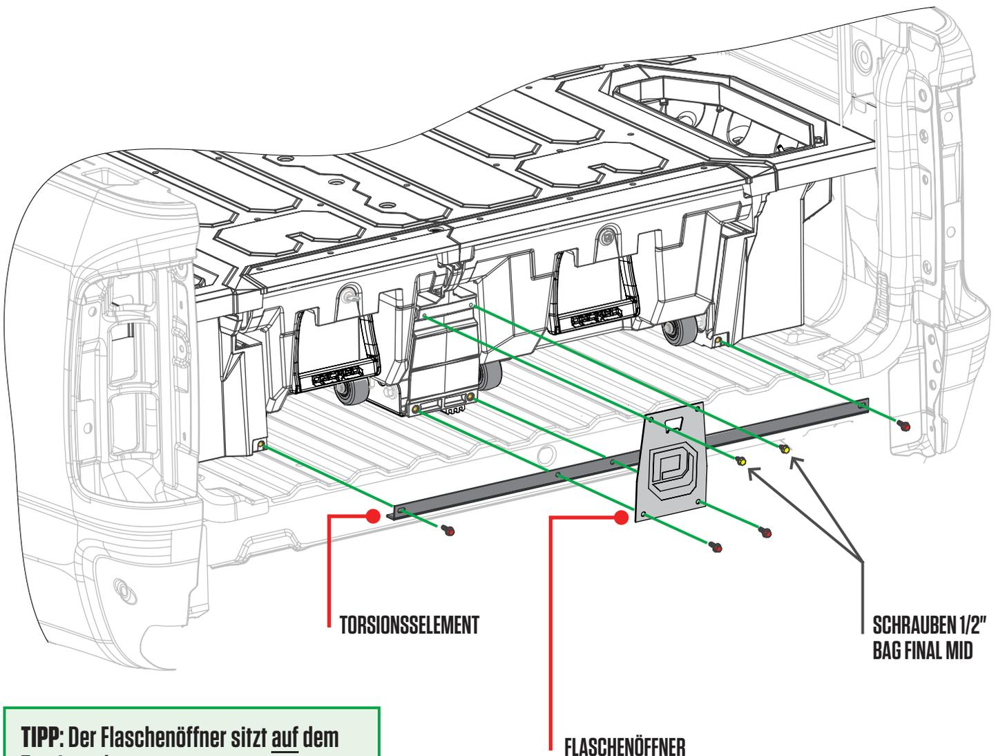
**TIPP:** Der Flaschenöffner sitzt auf dem Torsionselement.
