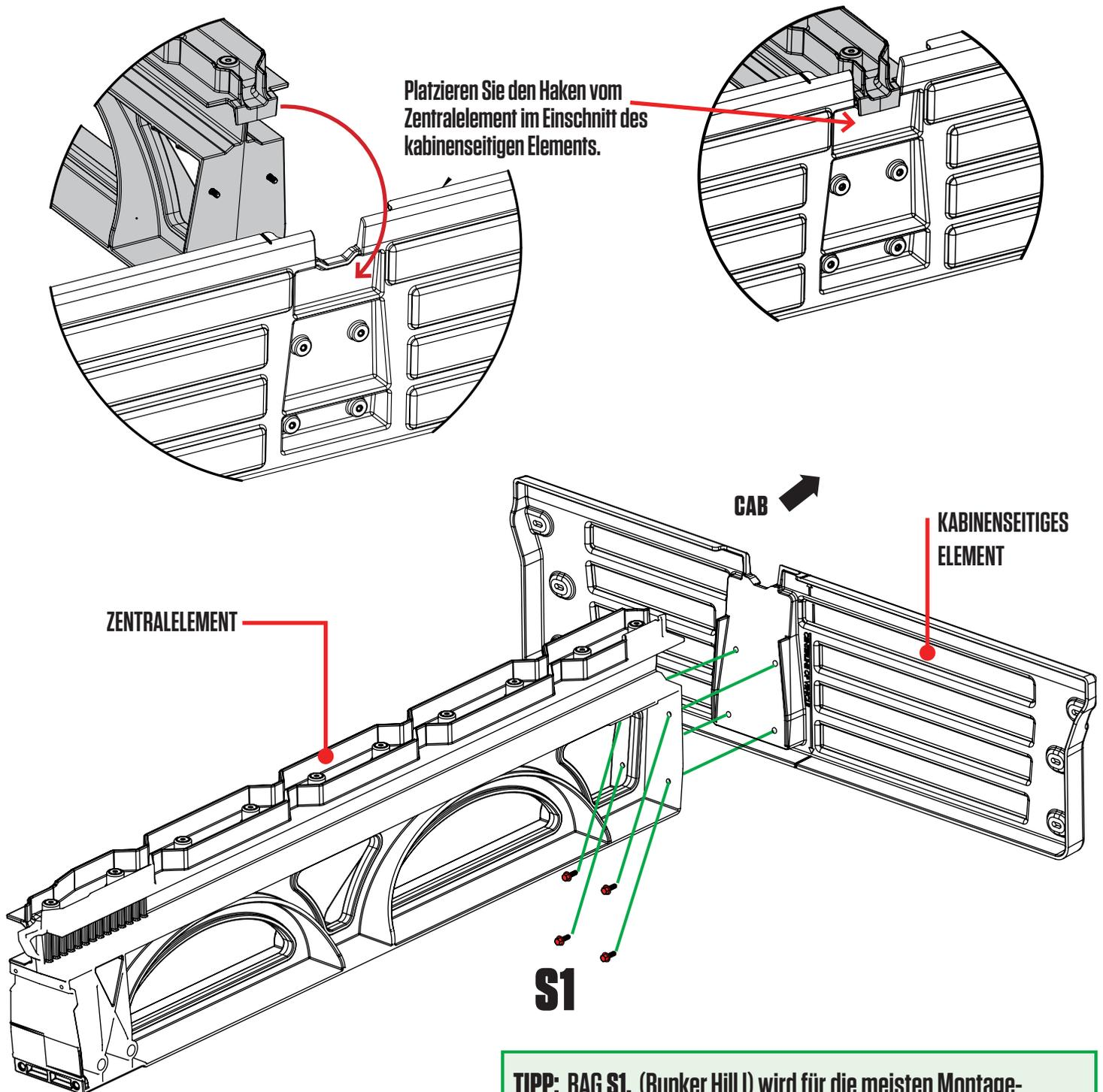
**TIPP: BAG S1, (Bunker Hill I) wird für die meisten Montageschritte benötigt, also passen Sie auf, dass Sie nichts verlieren! Diese Schrauben sind in den Anweisungen in **ROT** hervorgehoben.**
